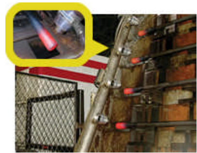
Modell 6042 2" (51mm) Adjustable Air Amplifiers mit Drehgelenken kühlen induktiv erwärmte Wellen vor der Installation der Naben.
