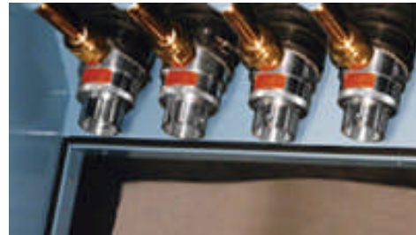
Einstellbare Luftstromverstärker werden im Luftkanalsystem eingesetzt, um saubere Luft für die Trocknung anzusaugen.
