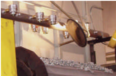
Mit Hilfe von verstellbaren Air Amplifiers (Venturidüsen), Modell 6042 (51mm) werden Metallteile getrocknet.
