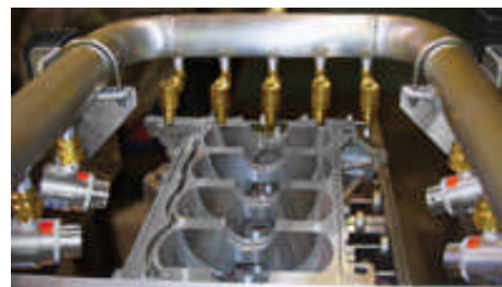
Verstellbare Air Amplifier und High Velocity Jets trocknen einen Motorblock vor dem Einbau.
