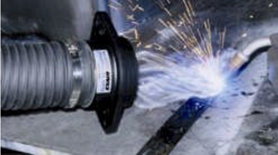
Der Super Air Amplifier, Modell 120024 (4") saugt entstehenden Rauch bei Schweißarbeiten ab.
