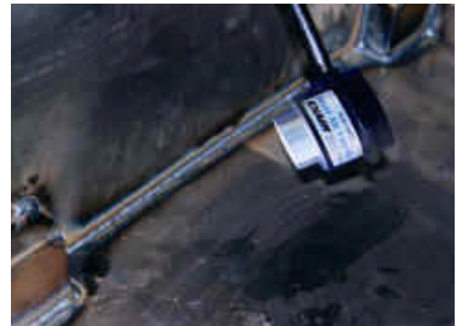
Mit einem Super Air Amplifier Modell 120022 (51 mm) wird eine Schweißnaht an einem großen Kühlmittel tank schnell abgekühlt.
