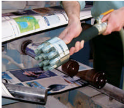
Die Super Blast Safety Air Gun, Modell 1213-12, bläst Papierstaub aus einer Papierrollenpresse und kommt mit seinem Luftstrom tief in die schwer zugänglichen Bereiche hinein.
