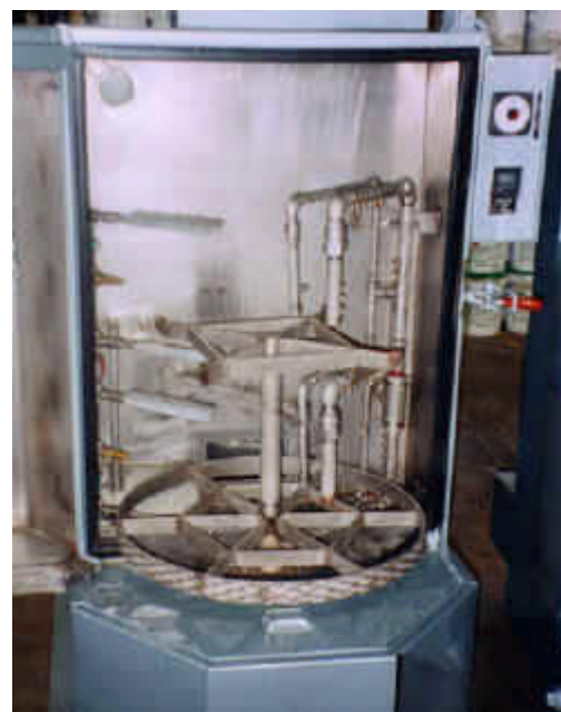
In dieser Werkstückwaschanlage erfolgt der Trocknungszyklus durch 3 Standard Air Knives Modell 2012 (305 mm).
