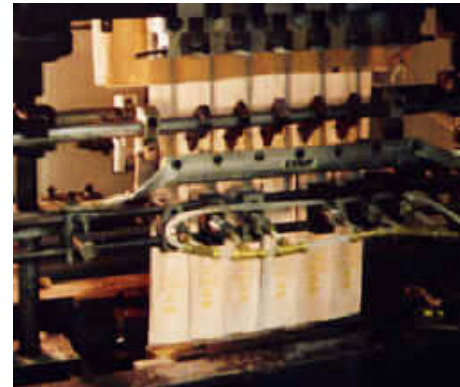
1 Standard Air Knife, Modell 2012 (305 mm), öffnet Senfpackungen vor dem Befüllen.
