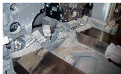
(5) Super Air Knives, Modell 110003, 3" (76mm), blasen Späne von der Aufspannvorrichtung, vom Werkzeug und der Fläche der Bohrstation
