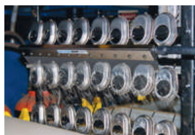
Ein Super Air Knife, Modell 110024SS 24" (610mm), aus Edelstahl trocknet Abdeckungen, die einen Glanzeloxierbehälter verlassen.
