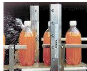
Mit (2) Super Air Knives, Modell 110012 (305 mm), wird vor der Etikettierung Wasser von Flaschen abgeblasen.
