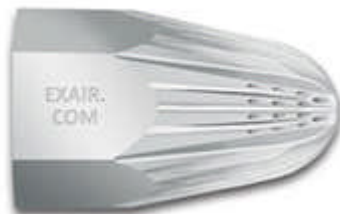
Large Super Air Nozzles 1.9 - 15 Pfund Kraft (850 - 6804 g) 35 - 300 SCFM (991 - 8495 l/min) Zink/Aluminium Edelstahl, Typ 316
