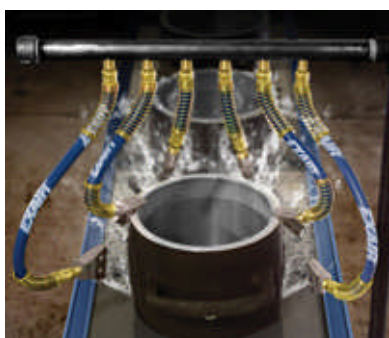
Flexible Stay Set Hoses™ (flexible, abgesteifte Schläuche) sind ideal, wenn häufiges Nachpositionieren von Abblasdüsen erforderlich ist.
