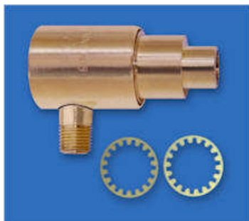
Das Modell 6313 Shim Set für den High Velocity Air Jet (siehe Foto) beinhaltet ein .006" (0.15mm) und ein .009" (0.23mm) dickes Shim. Ein .015" (0.38mm) ist werksseitig installiert.
