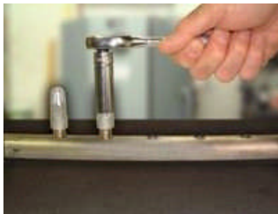
Die meisten Exair-Düsen können mit einem Standard-Imbus-Werkzeug installiert werden
