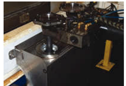
Nach der maschinellen Bearbeitung wird das angeflanschte Ende einer Welle durch ein Super Air Wipe geführt, um Späne wegzublasen.
