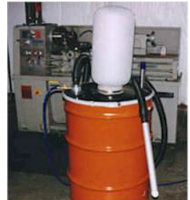
Die Späne können direkt zum Recycling in separate Fässer gesaugt werden.
