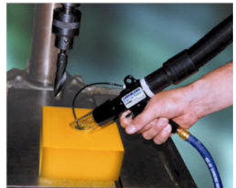
Mit einer Deep Hole Vac-u-Gun System Modell 6394 werden Späne aus einem gebohrten Kunststoffwerkstück entfernt.
