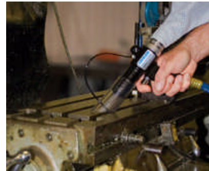
Das Modell 6194 Deep Hole Vac-u-Gun reinigt die Vertiefungen auf einer Fräsmaschine.
