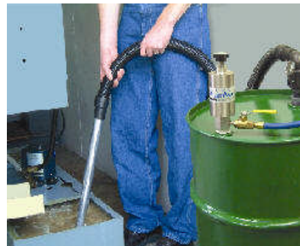
Mit einem Reversible Drum Vac System Modell 6196-30 (= 30 Gallon-Fass, ca. 112 l) wird der Kühlmittelsammelbehälter einer CNC-Maschine geleert.
