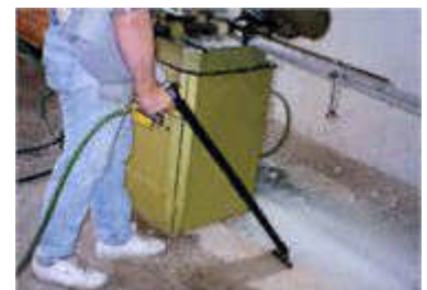
Modell 6192 Vac-u-Gun Staubsaugersystem mit Filter saugt Absorptionsmittel und Späne auf.
