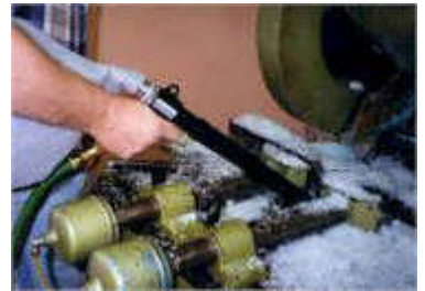
Modell 6392 Vac-u-Gun Allzweck-System entfernt Kunststoffspäne von einer Säge.
