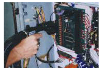
Modell 6292 Vac-u-Gun Transportsystem entfernt Staub von empfindlichen elektronischen Steuerungen.
