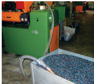
Das Line Vac, Modell 6083 1-1/2" (38mm), transportiert Kunststoffgranulat zum Fülltrichter an einer Strangpresse.
