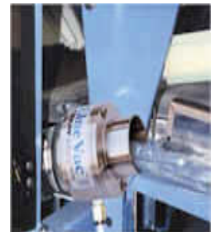
Mit dem Modell Line Vac 6084 (51mm) werden Papierschnitzel zu einer Abfalltonne transportiert.
