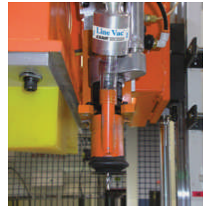
Ein Line Vac, Modell 6080, 3/4" (19mm), saugt Plastikspäne direkt nach dem Bohren ab.
