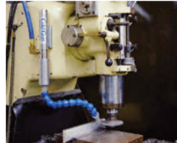
Modell 5215 Cold Gun System Fräsen und Bohren
