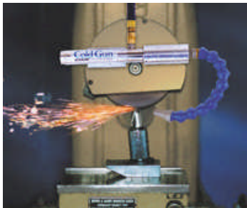
Modell 5215 Cold Gun System Schleifen von Werkzeugen
