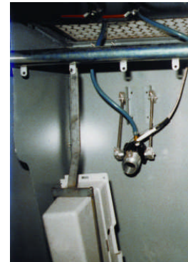
Ein Ion Air Cannon System, Modell 7292, entfernt statische Elektrizität und Staub vom Einsatz eines Handschuhfaches vor dem Beflocken oder Lackieren.
