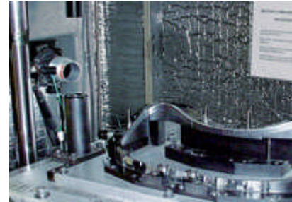
Das Ion Air Cannon System Modell 7292 beseitigt statische Elektrizität und Staub von Tachometergruppen vor dem Zusammenbau.
