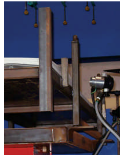
Das Ion Air Cannon System Modell 7292 beseitigt statische Elektrizität von Plastikfolien, um sie leichter trennen zu können.
