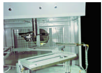
Das Standard Ion Air Knife System, Modell 7212 12" (305mm) reinigt Metallrahmen vor der Pulverbeschichtung.
