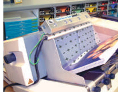
Das Super Ion Air Knife verhindert Stauungen bei gleichzeitiger Verbesserung der Druckqualität auf Inkjet-Adressiermaschinen.
