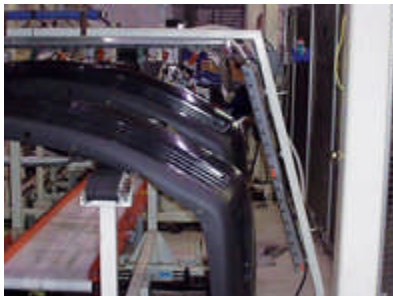
Stoßstangen, Karosserien und Instrumententafeln werden vor dem Lackieren von Staub und Fasern gereinigt.
