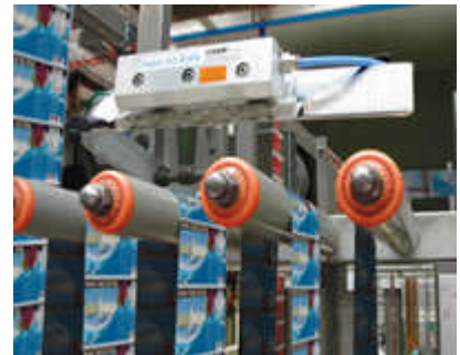
Das Super Ion Air Knife beseitigt die statische Aufladung auf Etiketten, die für PET Kunststoffflaschen verwendet werden.
