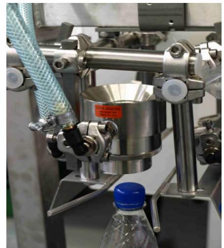
Ein Air Amplifier von EXAIR, wie er bei Krones zum ringförmigen Abblasen von Flaschenhälsen verwendet wird.
