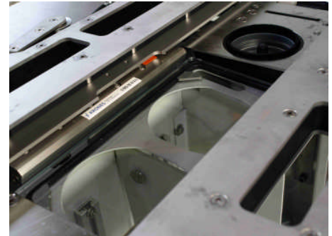
Air Knives verhindern, dass Verunreinigungen an Schutzgläsern von Beleuchtungs- bzw. Kamerasystemen entstehen.
