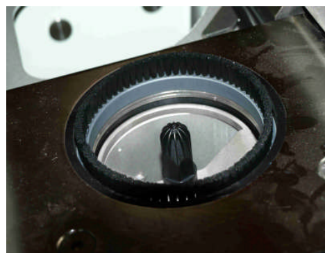
Air Nozzle zum Abblasen des Flaschenbodens vor der Bodeninspektion
