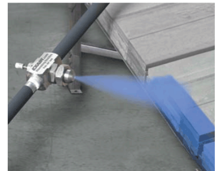
Zerstäuberdüse mit kleinem Austrittswinkel, Modell ANI010SS, eingesetzt zur Markierung von Stahlleisten, bevor diese das Walzwerk verlassen.
