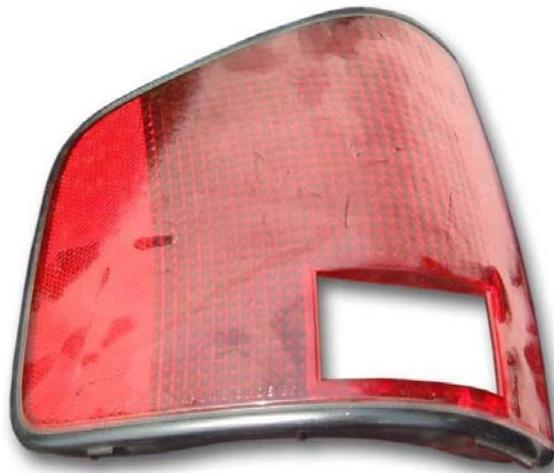
Normalerweise besteht jede Beleuchtungseinheit aus drei Hauptteilen: dem Reflektor, der auch das Gehäusehinterteil ist, der Streuscheibe (oben abgebildet) und den elektrischen Bauteilen. Bei Beleuchtungsherstellern gibt es mindestens drei mögliche gemeinsame Anwendungen, abhängig von den „örtlichen Bauweisen“ und dem Herstellungsverfahren, aber es kann noch mehr geben.
