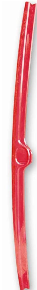
Reflektor/Gehäusehinterteil. Der Reflektor wird durch Aufbringen einer Silberbeschichtung auf der Innenseite des Reflektors/Gehäuses unter Verwendung eines Vakuum-Aufdampfverfahrens hergestellt. Vor dem Aufbringen der Beschichtung muss der Reflektor frei sein von statischer Ladung und der Staub entfernt werden. Sonst vergrößert der Hohlspiegel die Fehlstellen, die Silberbeschichtung hat schlechte Haftung, und der Lichtstrahl wird unregelmäßig; das führt zu Ausschuss.
