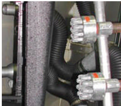
(2) Super Air Nozzle Clusters reinigen eine Fahrzeugverkleidung.
