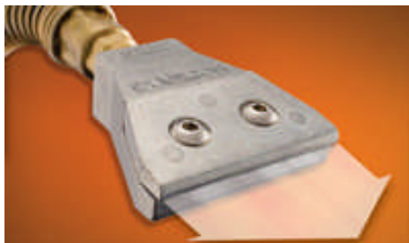
Kraft und Durchfluss können einfach erhöht oder verringert werden, indem verschiedene Shims (Abstandsfolien) installiert werden.
