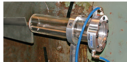
Das Standard Air Wipe bläst Kühlmittel bei einer Schleifmaschine ab.
