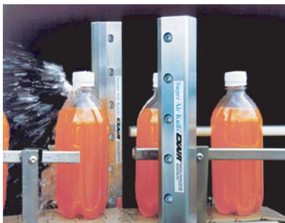
Mit (2) Super Air Knives, Modell I10012 (305 mm), wird Wasser von Flaschen abgeblasen.
