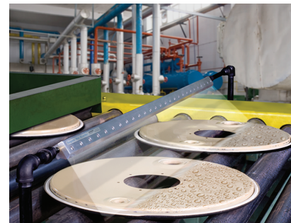
Das 54" (1.372 mm) Air Knife trocknet gestanzte Teile nach einer Reinigung.
