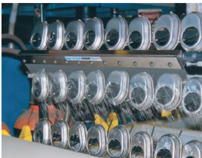
Ein Super Air Knife, Modell I10024SS 24" (610 mm), aus Edelstahl trocknet Abdeckungen, die einen Glanzeloxierbehälter verlassen.
