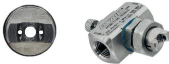
1/4" außenmischende Weitwinkel-Flachstrahldüsen sind ideal zum Auftragen großer Flüssigkeitsmengen auf einen weiten Bereich, wie z. B. bei Fertigungsstrecken. Weil sie außenmischend sind, können Luft- und Flüssigkeitsstrom unabhängig voneinander gesteuert werden. Zu den allgemeinen Anwendungsgebieten zählt das mäßige Auftragen von Flüssigkeiten auf einen breiten Bereich, z. B. das Kühlen oder Beschichten breiter Bahnen.
