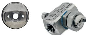
Außenmischende Flachstrahldüsen mit kleinem Austrittswinkel sind ideal zum Auftragen von großen Flüssigkeitsvolumina auf einen konzentrierten Bereich. Bei außenmischenden Sprühdüsen können Luft- und Flüssigkeitsstrom unabhängig voneinander gesteuert werden. Außenmischende Flachstrahldüsen mit kleinem Austrittswinkel eignen sich auch bestens für Anwendungen, bei welchen hochviskose Flüssigkeiten für dicke Beschichtungen auf einem schmalen Bereich aufzutragen sind, z. B. in Lackieranlagen.
