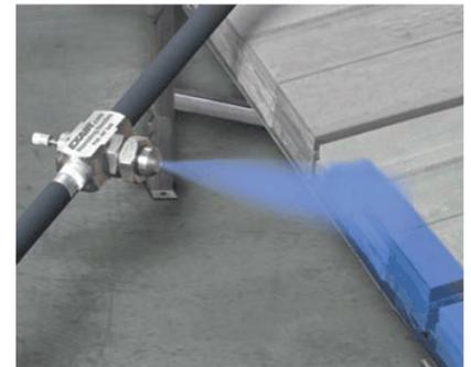
Zerstäuberdüse mit kleinem Austrittswinkel, Modell ANI1010SS, eingesetzt zur Markierung von Stahlleisten, bevor diese das Walzwerk verlassen.
