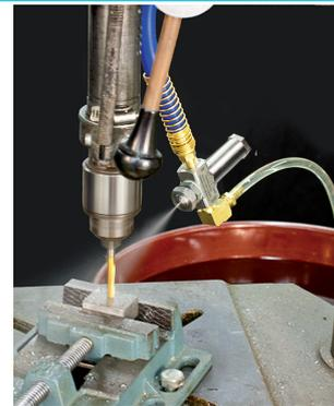
Ein Modell SR2010SS wird eingesetzt, um Werkstücke zu kühlen, bevor sie weiterverarbeitet werden.
