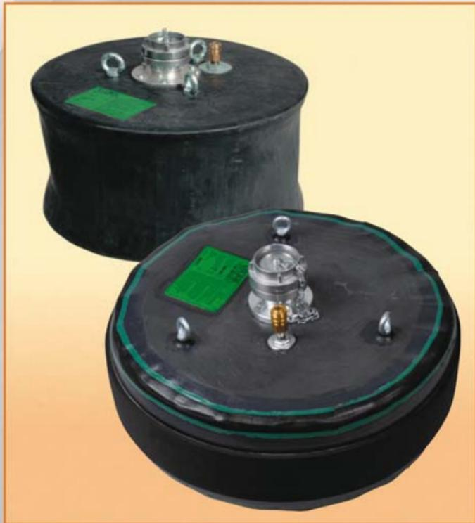
Diese Prüf-Dichtkissen eignen sich für Dichtheitsprüfungen der Standard-Schächte mit Wasser oder Luft nach DIN EN 1610. Sie sind leicht und kurz und können deshalb einfach gehandhabt werden. Es wird das gleiche Zubehör verwendet wie bei den üblichen Rohrdichtkissen. Auf Wunsch können Dichtkissen von einer anderen Form oder Größe hergestellt werden. Ausführung ist standard und leicht – L.
