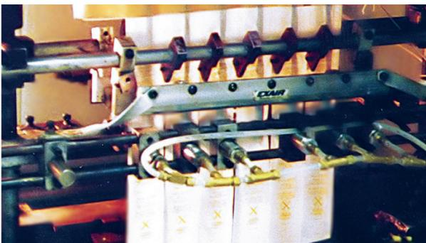
Beim **Standard Air Knife™** wird der Coanda-Effekt (Wandanhaftung einer Flüssigkeit bei hoher Geschwindigkeit) genutzt, um Luftbewegung in dessen Umgebung zu erzeugen. Unter Einsatz einer geringen Druckluftmenge als Energiequelle zieht das **Standard Air Knife** große Mengen Umgebungsluft ein, so dass ein Luftvorhang mit starker Strömung und hoher Geschwindigkeit für Abblasvorgänge entsteht.
