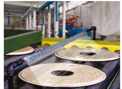
Das 54" (1.372 mm) Air Knife trocknet gestanzte Teile nach einer Reinigung.
