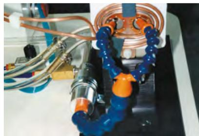
Ein Vortex Tube Modell 3215 kühlt eine Pressform an einer Maschine zur Herstellung von medizinischen Schläuchen.
