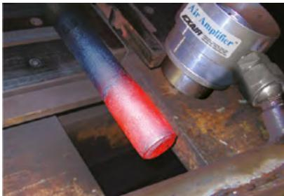
Der Adjustable Air Amplifier, Modell 6042, 51 mm (2"), mit Schwenkverschraubungen kühlt per Induktion erhitzte Achsen vor dem Zylindereinbau.
