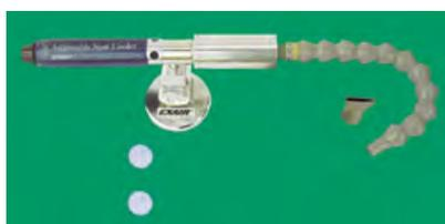
Modell 3825J Adjustable Spot Cooler System, bestehend aus dem punktuellen Kühler, einem Einspitzenschlauchsatz mit Rund- und Flachdüse, Drehmagnetfuß und (2) zusätzlichen Generatoren.
