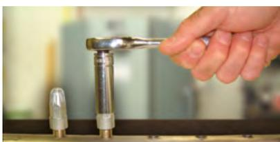
Alle Düsen können mit einem Standard-Inbus-Werkzeug installiert werden.
