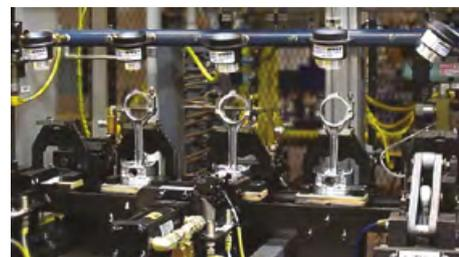
Fünf Modelle 120022 Super Air Amplifier 51 mm (2") kühlen LKW-Kolben vor der Messung.
