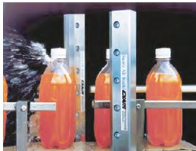
Mit (2) Super Air Knives, Modell 110012 (305 mm), wird Wasser von Flaschen abblasen.
