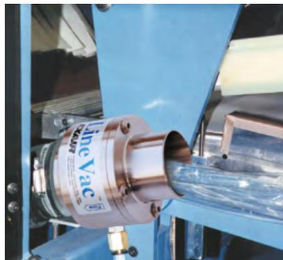
Mit dem Modell Line Vac 6084 (51 mm) werden Papierschnitzel oder Kunststoff-fäden transportiert
