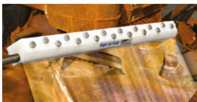
Die PVDF Super Air Knives haben PTFE Shims, Schrauben in Hastelloy C-276, Blindstopfen aus Edelstahl 316 und sind temperaturbeständig bis 135°C. Sie eignen sich für verschiedene Herstellungsprozesse, wie z.B. bei Solarzellen, Lithium-Batterien, Halbleiter bzw. in der Lösemittelrückgewinnung, Galvanik oder Medizintechnik.
