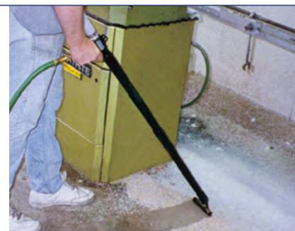
Modell 6192 Vac-u-Gun (Saug-System) mit Filter saugt Späne auf.
