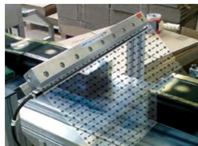
Das GEN4 Super Ion Air Knife entfernt Staub von Verpackungen für Körperpflegeprodukte, bevor die Boxen mit Zellophan versiegelt werden.
