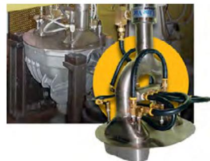
Ein Automobilhersteller saugt Späne mit einem Heavy Duty Line Vac, Modell 150200 51 mm (2") von Antriebsdifferentialen ab.
