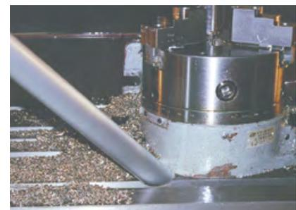
Der Chip Vac entfernt abrasive Edelstahlspäne von einer CNC-Fräsmaschine.
