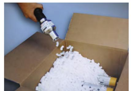
Ein Modell 130125 1-1/4" (32 mm) Light Duty Line Vac ist geeignet zum Befüllen oder Leeren der Chips von Versandpaketen.
