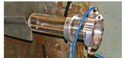
Das Standard Air Wipe bläst Kühlmittel bei einer Schleifmaschine ab.
