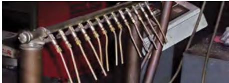
Verwirbelte Druckluft bläst direkt aus dem Schlauch oder Rohr. Neben der enormen Druckluftverschwendung werden auch die OSHA Druck-Anforderungen für tote Enden und Lärmpegel-Anforderungen verletzt.
