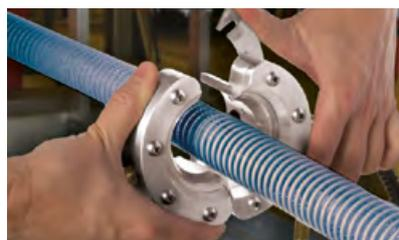
Die Konstruktion der Ringdüse lässt sich entriegeln und das Werkstück umfassen. Kein umständliches Einfädeln erforderlich.
