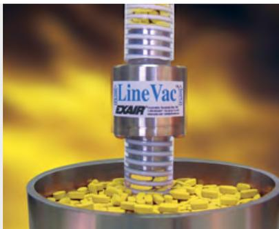
Ein Vakuumförderer aus Edelstahl (316) wird von einem Pharmaunternehmen für die pneumatische Förderung von Pillen und Tabletten zu einer Verpackungsstation benutzt.
