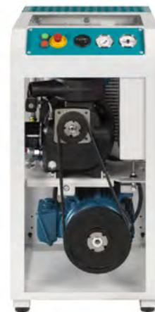
Öleingespritzter Schraubenkompressor: Innenansicht.
