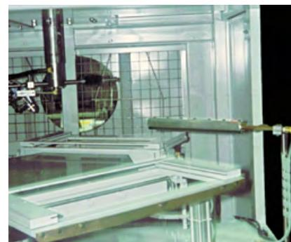
Das Modell 8112 GEN4 Standard Ion Air Knife System, 305 mm (12") reinigt Metallrahmen vor der Pulverbeschichtung.
