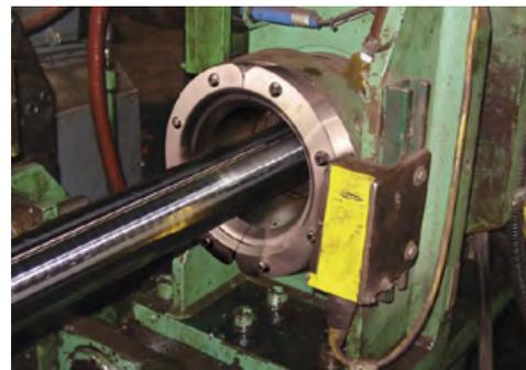
Ein Super Air Wipe, Modell 2404, 4" (102 mm) reinigt einen Stabstahl nach der Bearbeitung.
