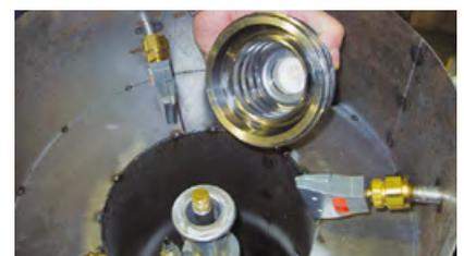
2" Flachstrahldüsen blasen Metallteile ab während sie durch eine Vakuumkammer gegeben werden.
