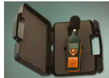
Jedes Schallpegelmessgerät enthält einen abnehmbaren "Windschutz" und wird inklusive Batterie in einem Koffer geliefert.
