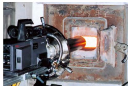
Spezielle Hochtemperatur-Vortex Tubes kühlen ein Boroskop-Objektiv beim Einführen in die Luke eines  $650^{\circ}\text{C}$  ( $1200^{\circ}\text{F}$ ) heißen Kessels.
