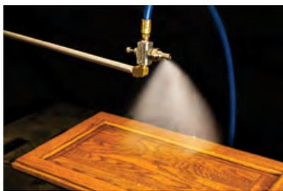
Ein Modell AD1010SS wird eingesetzt, um eine Schutzschicht auf Holzplatten aufzutragen.
