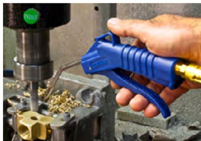
Die Präzisionsblaspistole ist mit der Nano Blasdüse ausgestattet, um Reste aus einer Bohrung zu entfernen.
