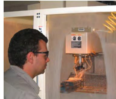
Mit einem Air Stik™ Modell 6201J wird die Glasfläche mit einem leisen Luftvorhang und hoher Geschwindigkeit abgeblasen.
