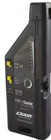
LED-Anzeigen am Ultraschall-Leckdetektor zeigen die genaue Quelle des Lecks oder Problems.
