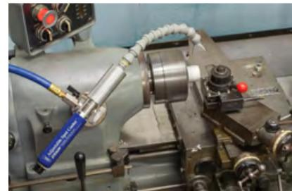
Der regelbare punktuelle Kühler hält kritische Toleranzen bei maschinell hergestellten Plastikteilen aufrecht.
