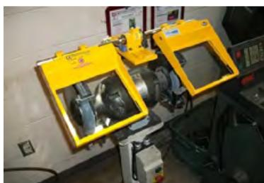
Die Schutzeinrichtung MO/2 mit zwei Glasschirmen für Schleifmaschinen ist sehr leicht zu montieren.
