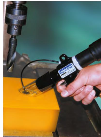
Mit einem Deep Hole Vac-u-Gun System Modell 6394 werden Späne aus einem gebohrten Kunststoffwerkstück entfernt.
