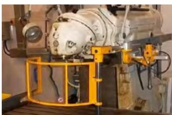
Die Schutzeinrichtung FAB für Fräsmaschinen ist auf einem ausgeglichenen, aus verchromten Stahlrohr realisierten Gelenkarm montiert. Eine Gasfeder hält diesen in Position.
