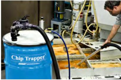
Der Chip Trapper saugt Kühlemulsion auf, um störende Späne herauszufiltern, die die Maschine blockieren können.
