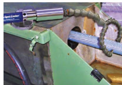
Ein PVC Schlauch wird am Ausgang der Strangpresse gekühlt und kann somit sofort aufgerollt werden.
