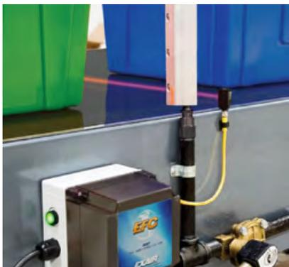
EXAIR's EFC ist ein elektronischer Strömungsschalter, der den Druckluftverbrauch und damit drastisch Kosten senkt, sobald kein Bauteil abzublase ist. Dies minimiert den Druckluftverbrauch bei Abblas-, Trocknungs-, Kühlungs-, Förder- und Antistatikanwendungen. Der EFC kombiniert einen fotoelektronischen Sensor mit einer Zeitsteuerung, die die Druckluftnutzung begrenzt, indem sie diese abschaltet, wenn kein Objekt vorhanden ist.
