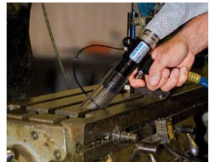
Das Modell 6194 Deep Hole Vac-u-Gun reinigt die Vertiefungen auf einer Fräsmaschine.
