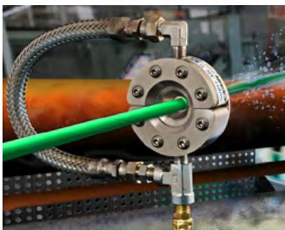
Das Super Air Wipe von EXAIR, 1/2"-Durchmesser, trocknet einen Draht unmittelbar nach dem Verlassen eines Kühlbades.
