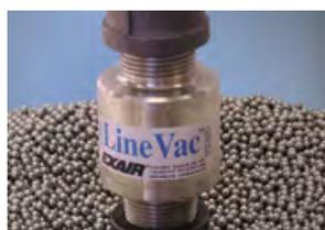
Ein Hersteller von kugelgelagerten Laufschiene befördert Kugellager mit dem Modell 141125 1-1/4" (32 mm) zu einer Bearbeitungsstation.
