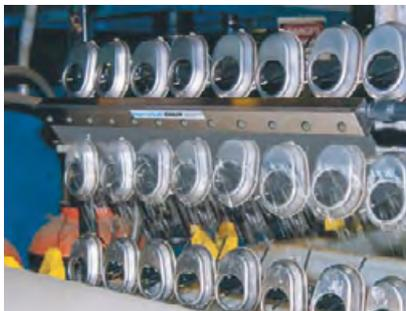
Ein Super Air Knife, Modell 110024SS 24" (610 mm), aus Edelstahl trocknet Abdeckungen, die einen Glanzeloxierbehälter verlassen.
