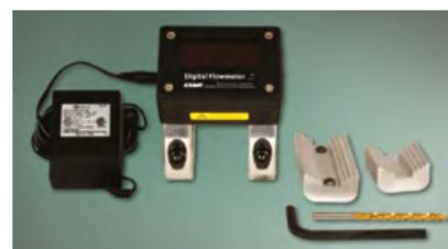
Jedes Digitale Durchflussmessgerät wird vollständig mit Netzteil 24 VDC, Bohrer 3/16" und Bohrvorrichtung geliefert.
