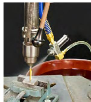
Ein Modell SR2010SS wird eingesetzt, um Werkstücke zu kühlen, bevor sie weiterverarbeitet werden.
