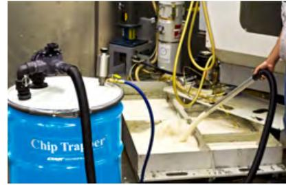
Danach pumpt der Chip Trapper die gefilterte Kühlemulsion zurück in die Wanne – frei von Spänen/Splintern.
