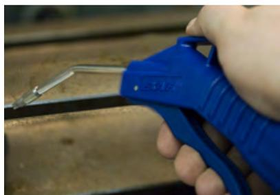
Die Präzisionsblaspistole 1410SS ist mit der Nano Blasdüse ausgestattet um eine T-Nut auszublasen.
