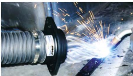
Modell 120024 Super Air Amplifier 102 mm (4") saugt entstehenden Rauch bei Schweißarbeiten ab.
