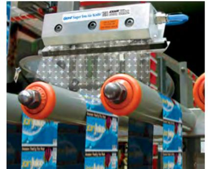
Das GEN4 Super Ion Air Knife eliminiert die statische Aufladung beim Etikettieren von PET Getränkeflaschen.
