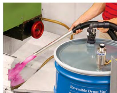
Mit dem Modell 6196-30 (ca. 112 Liter) wird der Kühlmittelsammelbehälter einer CNC-Maschine geleert.
