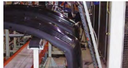
Stoßstangen, Karosserien und Instrumententafeln werden vor dem Lackieren von Staub und Fasern gereinigt.
