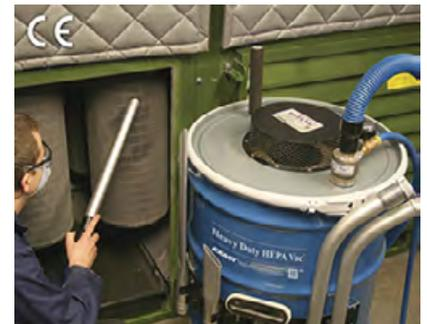
Ein verstopftes Filtersystem in einer Polierzelle wird mit dem Heavy Duty HEPA Vac schnell gereinigt und ist somit wieder nutzbar.
