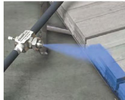
Zerstäuberdüse mit kleinem Austrittswinkel, Modell AN1010SS, eingesetzt zur Markierung von Stahlleisten, bevor diese das Walzwerk verlassen.
