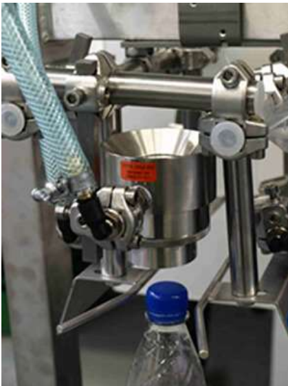
Ein Luftstromverstärker (Air Amplifier™) von EXAIR, wie er bei Krones zum ringförmigen Abblasen von Flaschenhälsen verwendet wird.
