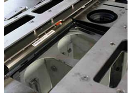
Air Knives™ verhindern, dass Verunreinigungen an Schutzgläsern von Beleuchtungs- bzw. Kamerasystemen entstehen.
