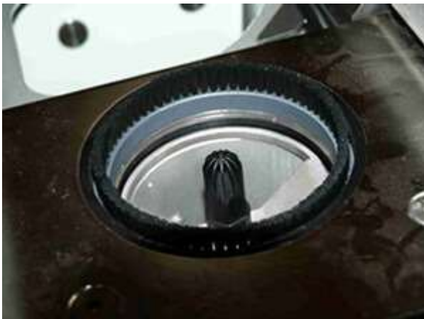
Air Nozzle™ zum Abblasen des Flaschenbodens vor der Bodeninspektion
