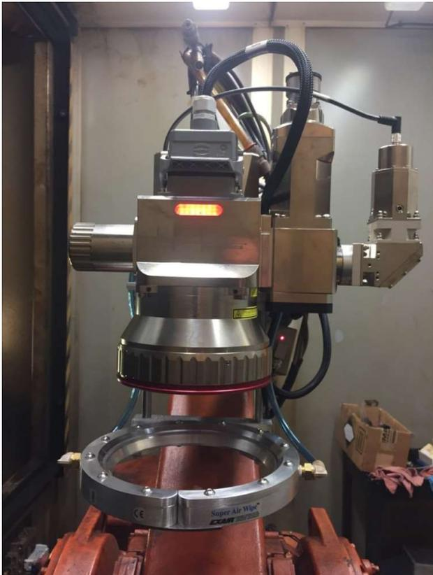
Schweißroboter mit EXAIR Super Air Wipe™ ausgestattet
