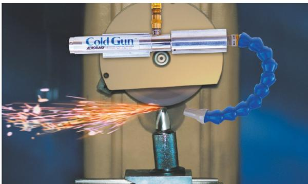
Unser Kaltluftpistolen-System produziert einen Strahl sauberer, kalter Luft bei 28 °C unter der Versorgungslufttemperatur.
