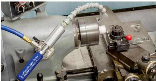
Das regelbare punktuelle Kühler-System erzeugt verschiedene Luftströme und Temperaturen durch die Einstellung des Drehknopfes und dem kleinen, eingebauten Bauteil, das sich Generator nennt.
