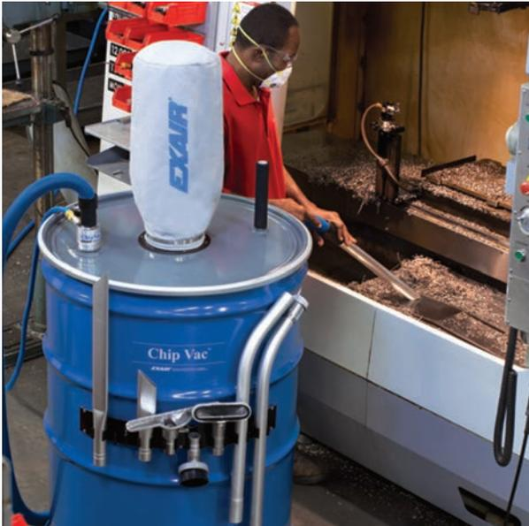
Das Modell Chip Vac ist ein leistungsstarker Industriesauger für das Aufsaugen der Späne. Der Fassdeckel mit Hebelschloss passt auf ein gewöhnliches 205-Liter-Fass und innerhalb von ein paar Minuten ist der Chip Vac einsatzbereit. Das ständige Anheben und Ausleeren von Schmutzfanggefäßen entfällt, denn das Gerät kann problemlos auf ein anderes Fass aufgesetzt werden. Durch den Einsatz von Druckluft mit 5,5 bis 6,9 bar werden Späne u.ä. angesaugt.
