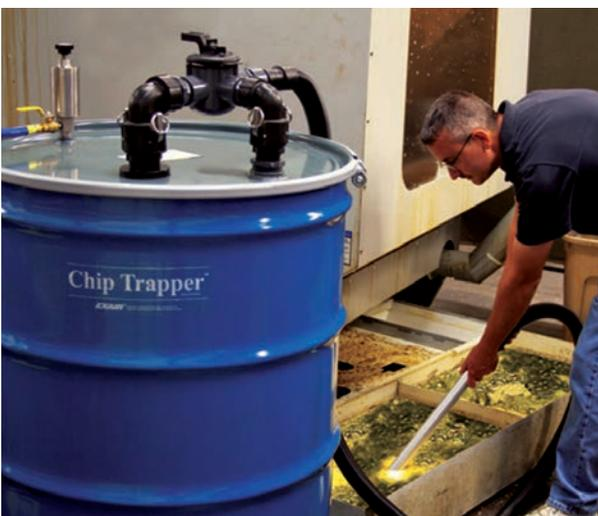
Sie möchten Kühlmittel oder Emulsionen von Spänen bzw. anderen Feststoffen trennen, um die extrahierte und somit saubere Flüssigkeit wieder in den Kreislauf zu bringen? Mit dem Modell Chip Trapper ist dies möglich.
