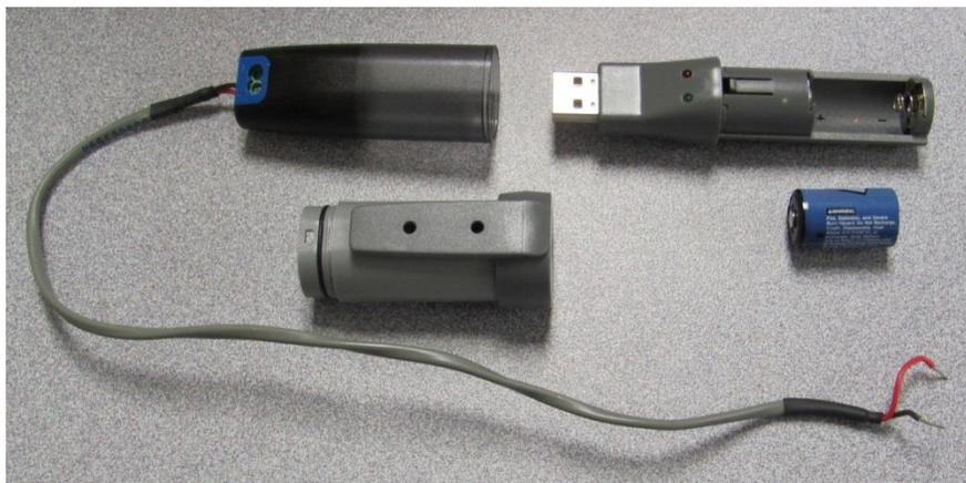
**Teil 1 – Den DATENLOGGER, Modell 9147, aus dem Datenkabelgehäuse ziehen und die Batterie einlegen.**
