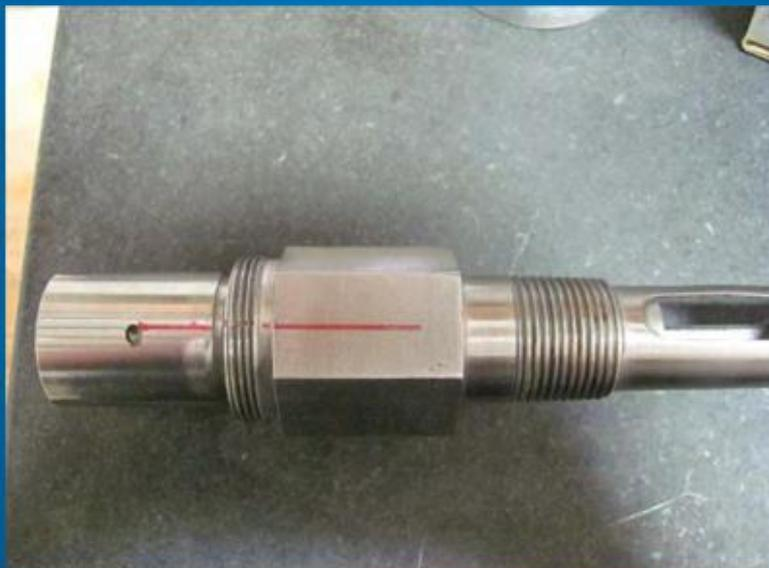
**Nachdem der Schalldämpfer abmontiert wurde, markieren Sie die Position zwischen Zapfen/Spund und Hauptteil, so dass nach der Reinigung die Einheit wieder richtig montiert werden kann.**
