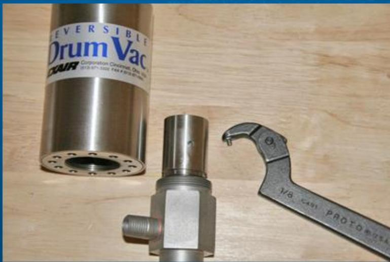
**Nach Demontage der Schalldämpfereinheit mit Hilfe eines Hakenschlüssels den Gewindestopfen ausschrauben.**
