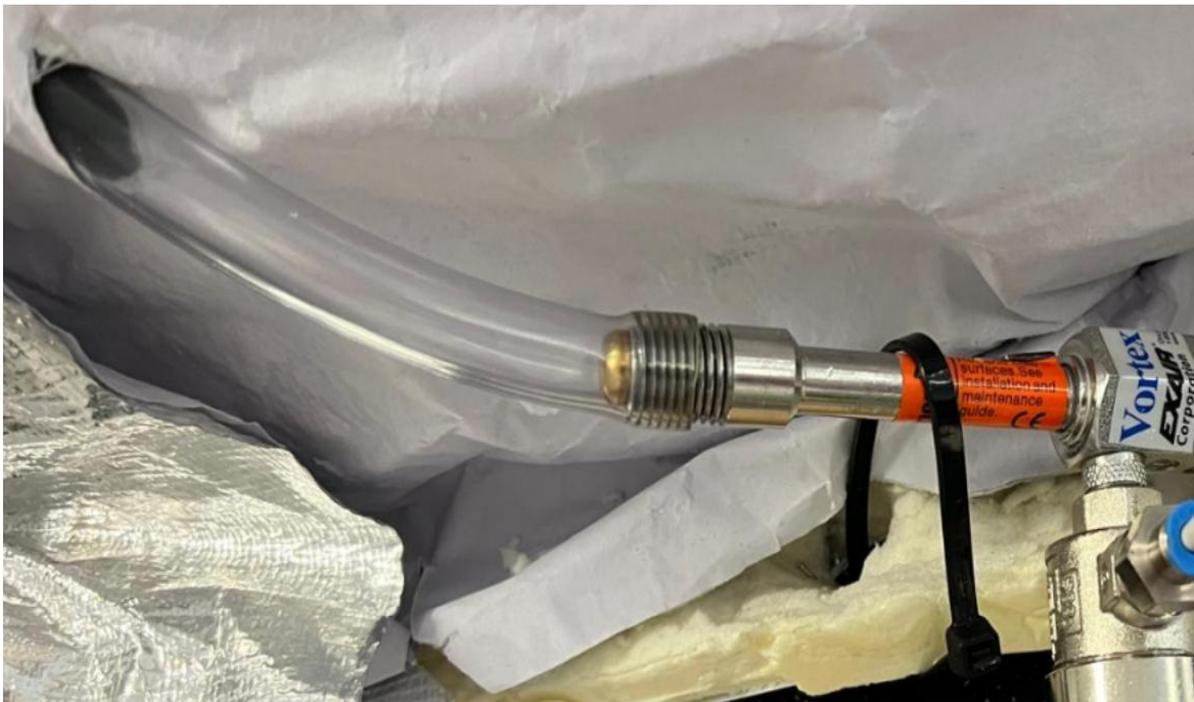
Abbildung 17: Einfaches Schlauchende für warmen Luftstrom
