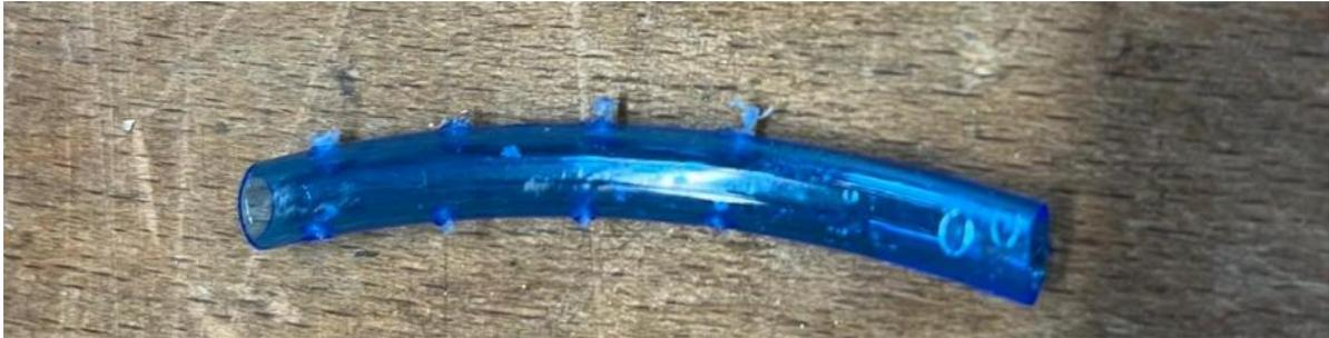
Abbildung 18: Versuch mit Schlauchende für warmen Luftstrom mit Querbohrungen
