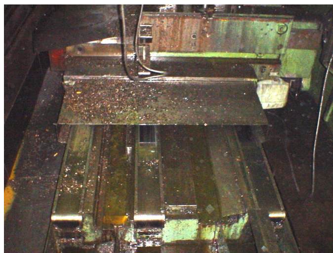
Auf Gleitbahnen zu sehende Späne
