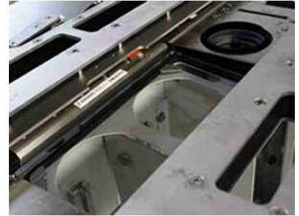
Air Knives™ verhindern, das Verunreinigungen an Schutzgläsern von Beleuchtungs- bzw. Kamerasystemen entstehen.
